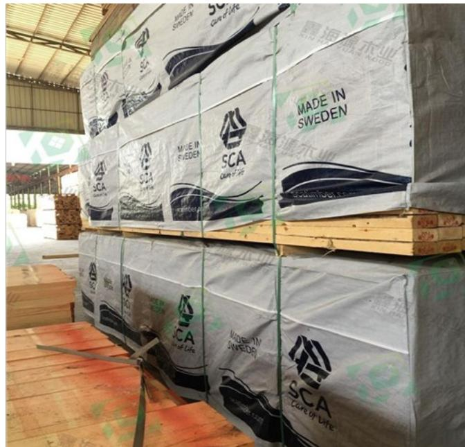
木方，俗称为方木，将木材根据实际加工需要锯切成一定规格形状的方形条木，一般用于装修及门窗材料，结构施工中的模板支撑及屋架用材，或做各种木制家具都可以。主要由松木、椴木、杉木等树木加工成截面长方形或正方形的木条。是装修中常用的一种材料，有多种型号，用于撑起外面的装饰板，起支架作用。天花吊顶的木方一般松木方较多。一般规格都是4米长，有 $2*3\text{cm}$ 的， $3*4\text{cm}$ 的， $4*4\text{cm}$ 的等。规格特点1、木方的规格一般分为 $30*50$ 毫米的，这个指的是它的长和宽我们叫35方，这个一般是用来吊棚做木龙骨用的，或者做一些造型的内部结构用的。还有 $60*90$ 的我见过的老式的家具的框架就是用这个做的，但是几乎在家庭装修里很少看见了广西
